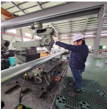
PIPE 홀 타공
